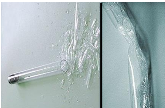
Rys. 2 Stłuczony promiennik - bez folii antyrozryzgowie (po lewej) i z folią (po prawej)
